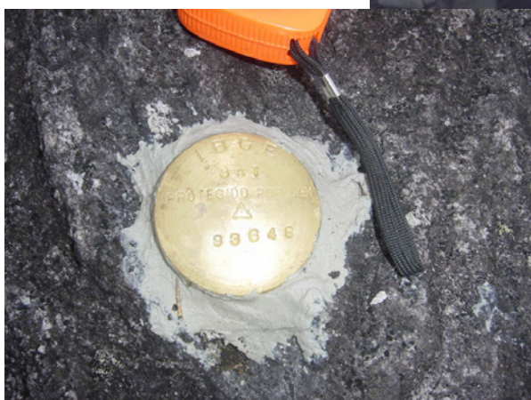
Coleta de dados realizada, em campo. GPS geodésico posicionado sobre estação geodésica passiva, uma chapa cravada em rocha no Pico da Neblina.
